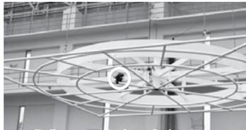
可動式カメラ架台 丸印がカメラ
