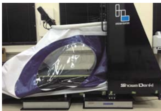
図4. 体重免荷式トレッドミル（ドリームハンター、昭和電機製） [フォースプレート上にDHを載せ、走行中の地面反力を計測]
