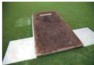
(注2) 投打マルチ解析システム: フォースプレート完備のピッチャーマウンド・バッターボックスで、ピッチャーとバッターの同時測定が可能(写真はマウンド)
