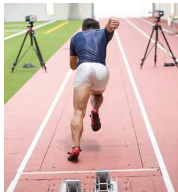
(注1) フォースプレート: 歩行や走行など動作をする際にかかる力量を測定できる機器
