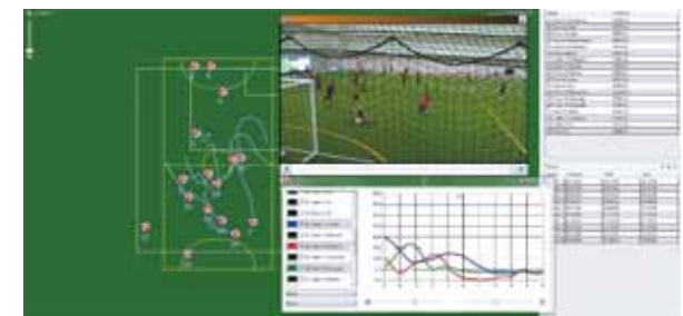
(注4) オブジェクトトラッキングシステム: 選手に装着したセンサーから座標位置、移動速度、身体の向き、心拍数などの情報を無線方式でかつリアルタイムに測定可能な機器
