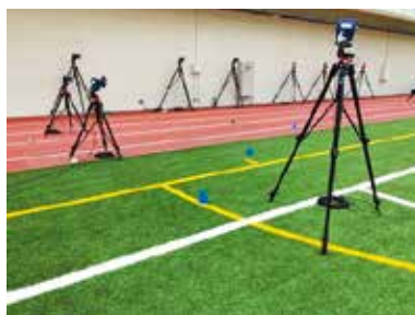
写真2 3次元MCの設置
