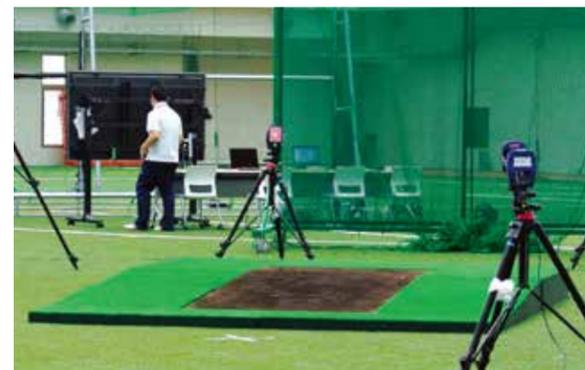
(図2) フォースプレート一体型マウンドおよびバッターボックス
