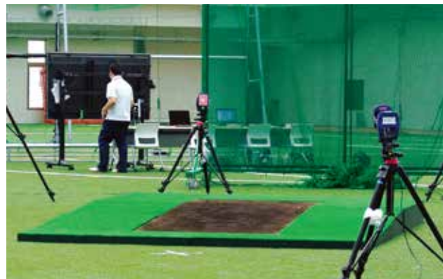
(図2) フォースプレート一体型マウンドおよびバッターボックス フォースプレート完備のピッチャーマウンド・バッターボックスで、投手と打者の同時測定が可能(写真はマウンド)
