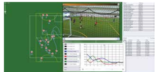
(図4) オブジェクトトラッキングシステム：選手に装着したセンサーから座標位置、移動速度、身体の向き、心拍数などの情報を無線方式でリアルタイムに測定可能な機器
