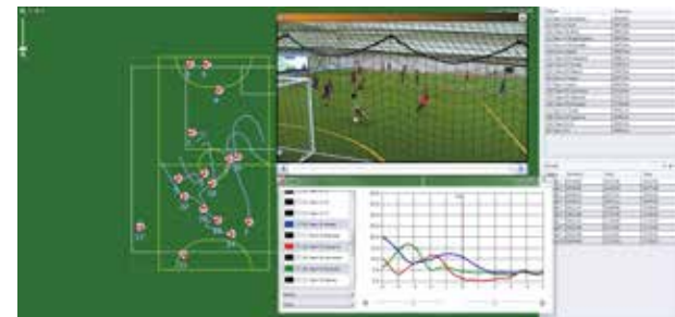
(図4) オブジェクトトラッキングシステム：選手に装着したセンサーから座標位置、移動速度、身体への向き、心拍数などの情報を無線方式でリアルタイムに測定可能な機器
