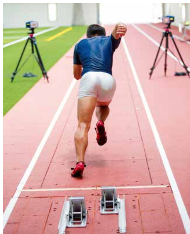
(図1) フォースプレート 走行直線にフォースプレートを54枚設置（スタート地点を含む） 歩行や走行などの動作を行う際の地面反力を測定できる機器
