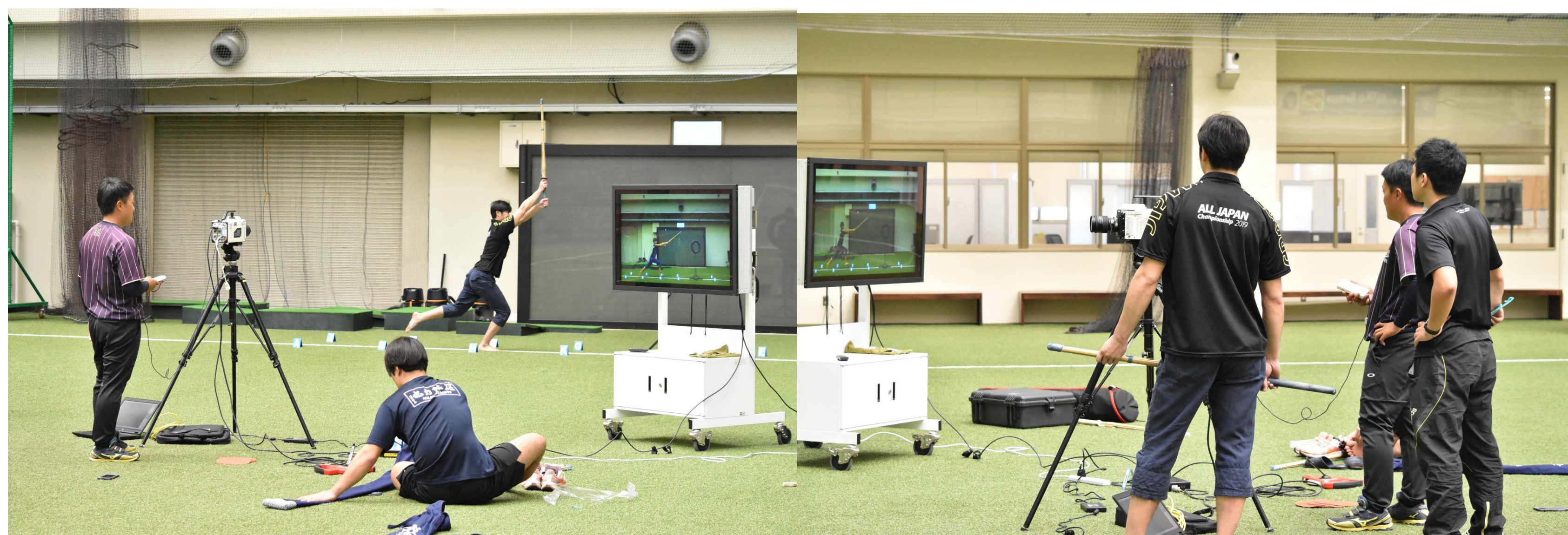
図2 ハイスピードカメラによる「剣道」の動作解析
