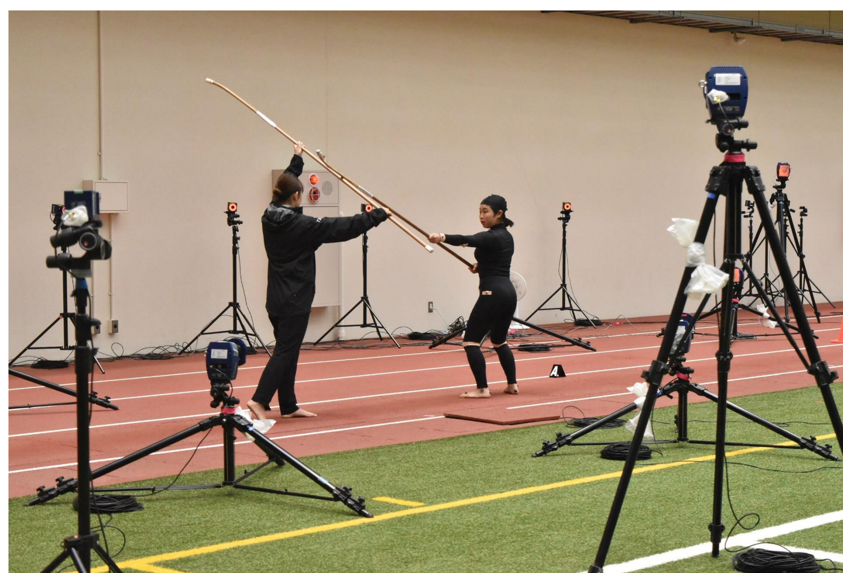
図3 モーションキャプチャーシステムによる「なぎなた」の動作解析
