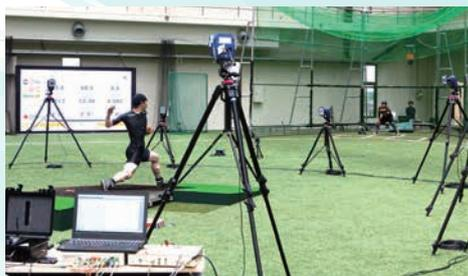
トラックマン（Trackman）やラプソド（Rapsodo）を使用して、投球時の「球速、回転数、回転軸、リリースポイント、球の軌道など」を測定します。また、フォースプレートやモーションキャプチャーシステムを用いることで、投球動作を三次元で解析し、自身のパフォーマンス向上に役立てています。
