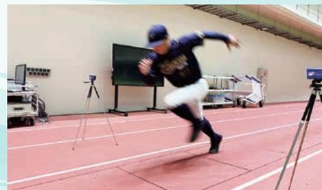
フォースプレートが連続して埋め込まれているタータンの上で、塁間距離の「疾走スピードやピッチ数、ストライド幅など」を測定します。ランニング能力を客観的な数値にすることで、トレーニングの質向上に繋がっています。
